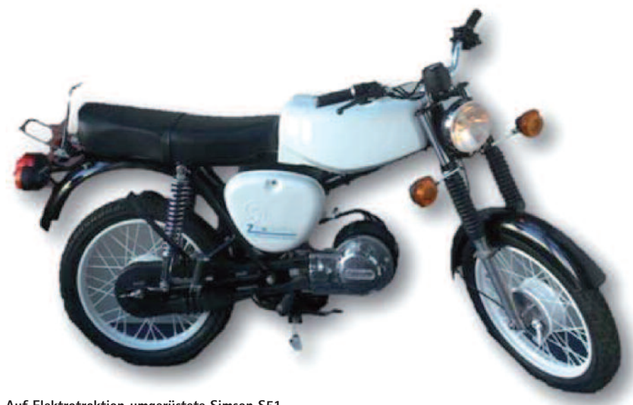
Auf Elektrotraktion umgerüstete Simson S51
