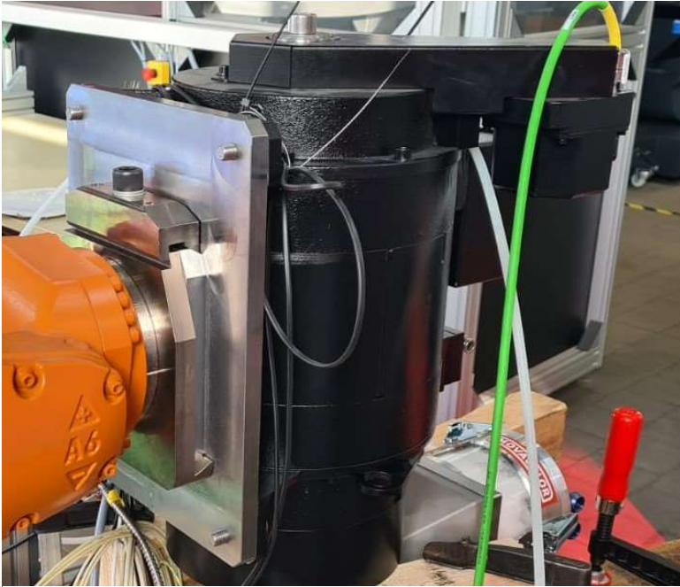
Abbildung 6: Extruder mit Konsole am Roboterarm
