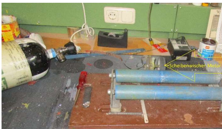
Abb. 1-2 Vorhandene Drehvorrichtung - Foto: P. Kramer
