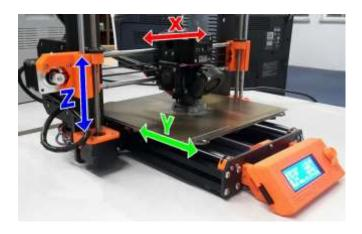
Durch Verlegen des Riemens kann der Druckkopf in X- und Y-Richtung mit nur zwei Motoren bewegt werden. Das Druckbett steht still und bewegt sich nur in Z-Richtung nach unten.
