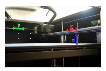
Hierbei bewegt sich das Druckbett vor und zurück, während der Druckkopf sich nach links und rechts bewegt. Über zwei Spindeln wird der Druckkopf zusätzlich in Z-Richtung verfahren.
