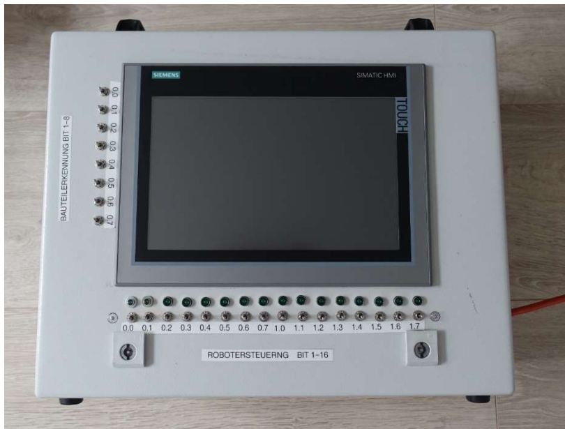
Abb. 8: Schaltschrank mit Netzteil, CPU, HMI und Kippschaltern
