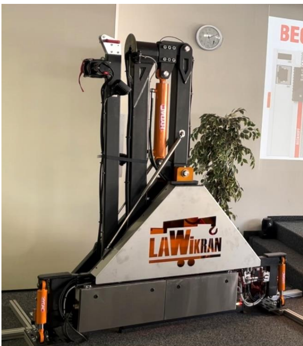
Abbildung 7: LaWiKran mit aufgestelltem Hauptmast
