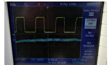
Abbildung 4: Rechtecksignal des Drehzahlausgangs mit Pull-Up Widerstand
