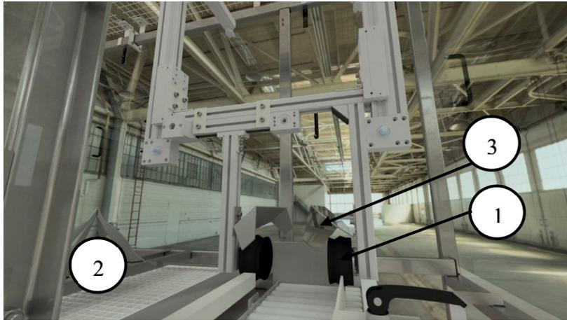
Ist der Beutel erkannt, fährt die Lineareinheit mit Saugnäpfen (1) an den Beutel, um ihn zu greifen, und transportiert ihn über die Keilspitze (2). Die ausgewählten Saugnäpfe sind speziell für unebene Konturen geeignet und
