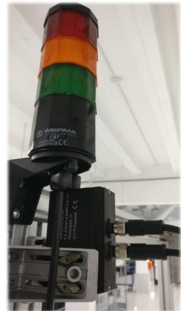
Abbildung 5: Montierte Warnleuchte und Sicherheitsverriegelung der Tür
