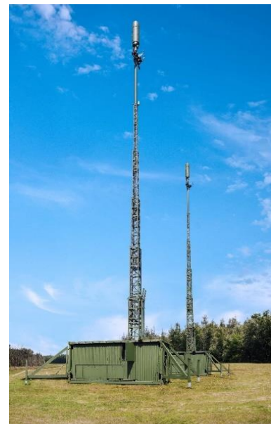
Aufgestellte Antennenträger im Feld ohne LKW
