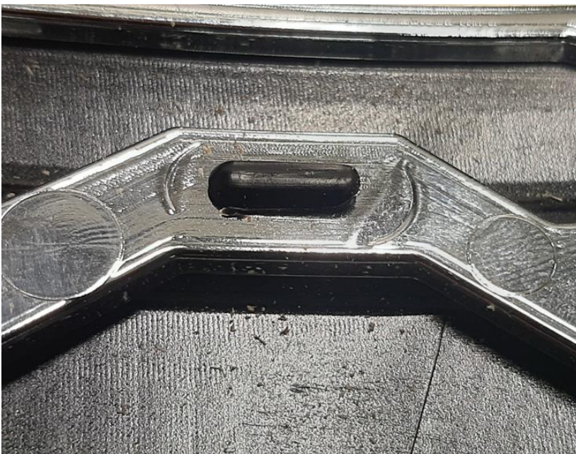
Abbildung 10 Fügeergebnis mit umgestaltetem Prägestempel
