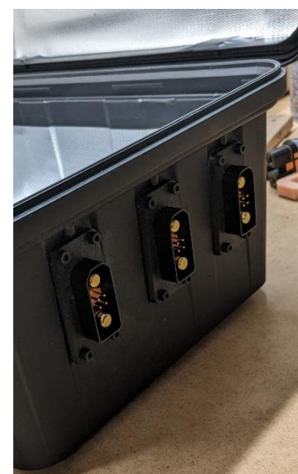
Gehäusedurchführung, ausgelegt auf 200 A Spitzenströme
