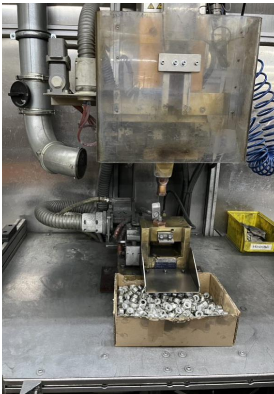
Abbildung 1: Buckelschweißanlage vor Umbau
