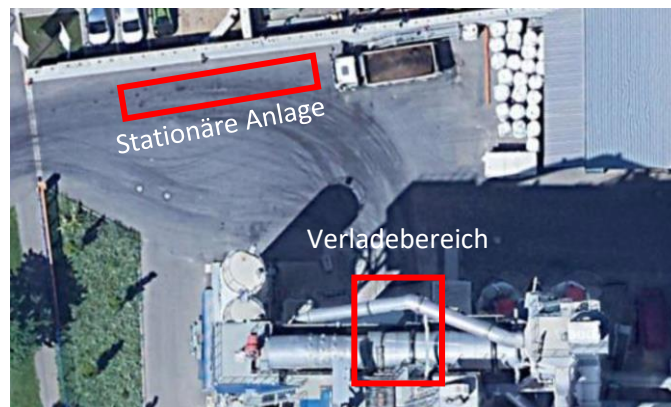
Abbildung 2: Position der Temperaturmessanlage an einer Beispiel-Mischanlage
