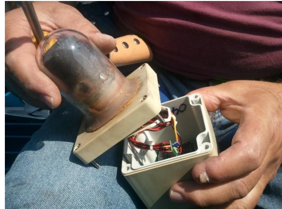
Abbildung 2: Sensor der alten Schattenabschaltung
