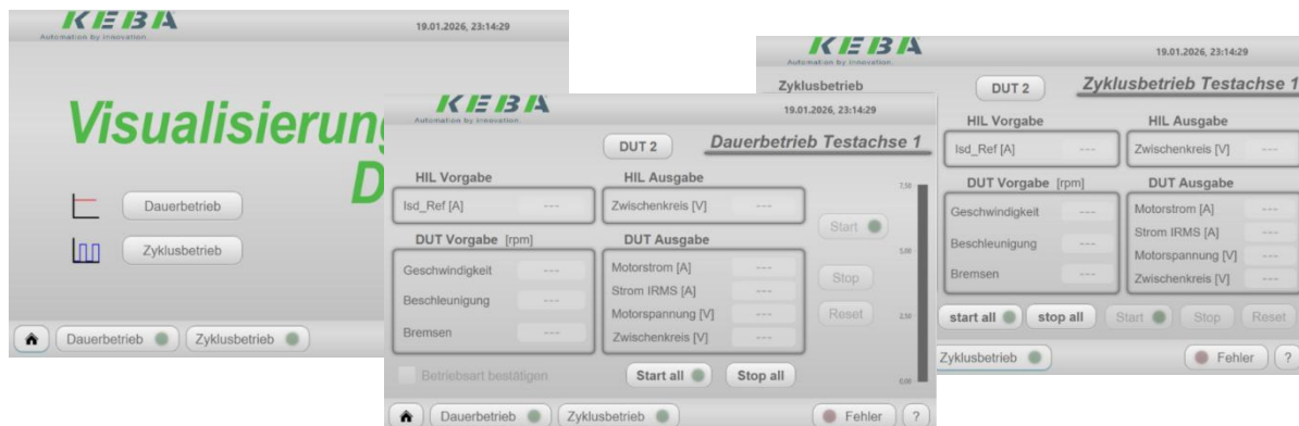
Abbildung 9: HMI-Visualisierung mit Startseite und den beiden Seiten für Dauer- und Zyklusbetrieb
